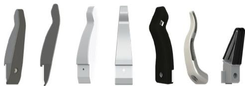
Diferentes tarefas necessitam de diferentes e otimizados manipuladores. Para proporcionar um processo autônomo a TARGET fornece uma ampla linha de manipuladores desenvolvidos para os mais variados objetos. Os manipuladores podem ser desenvolvidos especificamente a sua operação, inclusive com vácuo. Com a opção de pinças sensorizadas, é possível realizar a integração do sinal com o manipulador PGRIP.
